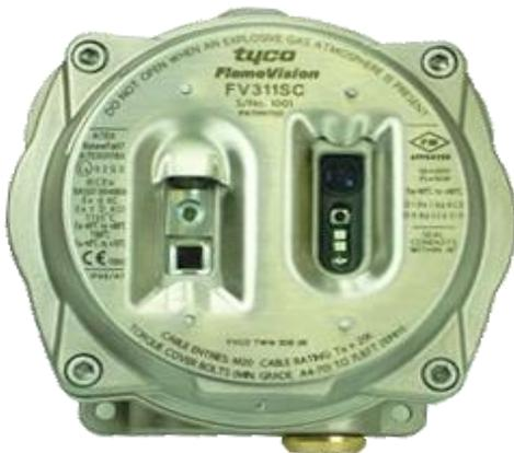
El Scott Safety FV-300 FLAMEVision es un revolucionario instrumento de detección de llama que utiliza una matriz de plano focal (FPA) de 256 sensores infrarrojos como elementos sensores para localizar la posición angular de un incendio dentro del campo de visión.
